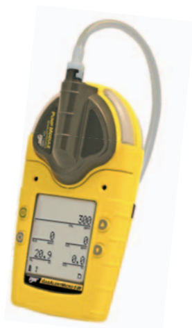
配上连体泵的 GasAlertMicro 5 IR
